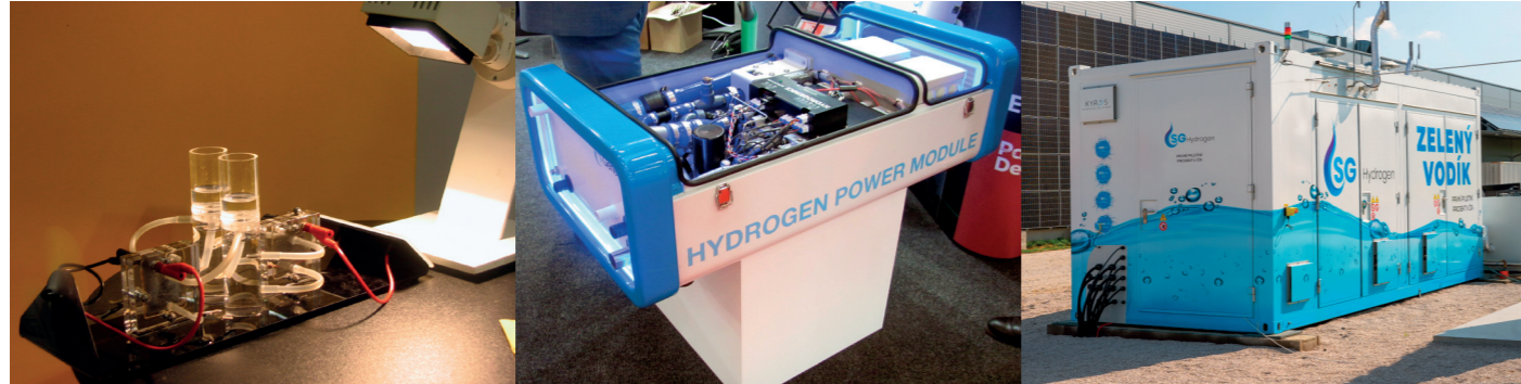
Přesně podle Komenského – od jednoduchého po složitější: Od školního demonstračního modelu elektrolyzátoru produkujícího vodík k malému komerčnímu elektrolyzátoru s výkonem 15-45 kW a k průmyslovému elektrolyzátoru s produkcí 82 kg vodíku za den. Foto B. Koč (1, 2), SG Hydrogen Napajedla (3)
