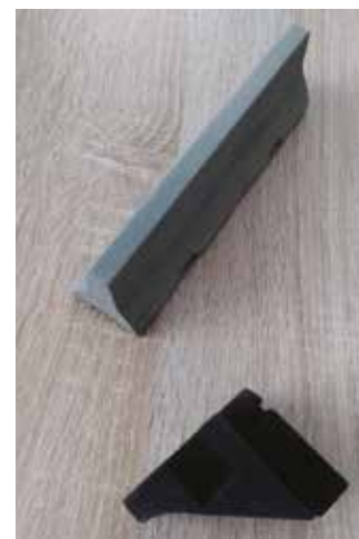
Pěnové pružinové odlitky Flexible foam casts (© foto/photo: TU Liberec)
