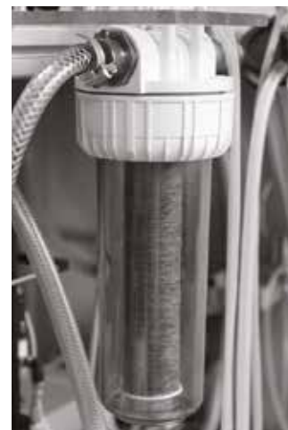
Filtr s kompozitní přízí Filter with composition yarns (©foto/photo: Jiří Pstružina)
